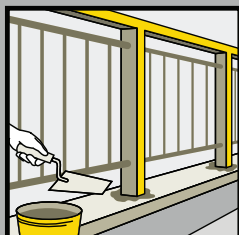
Postavljanje rukohvata na ogradi
